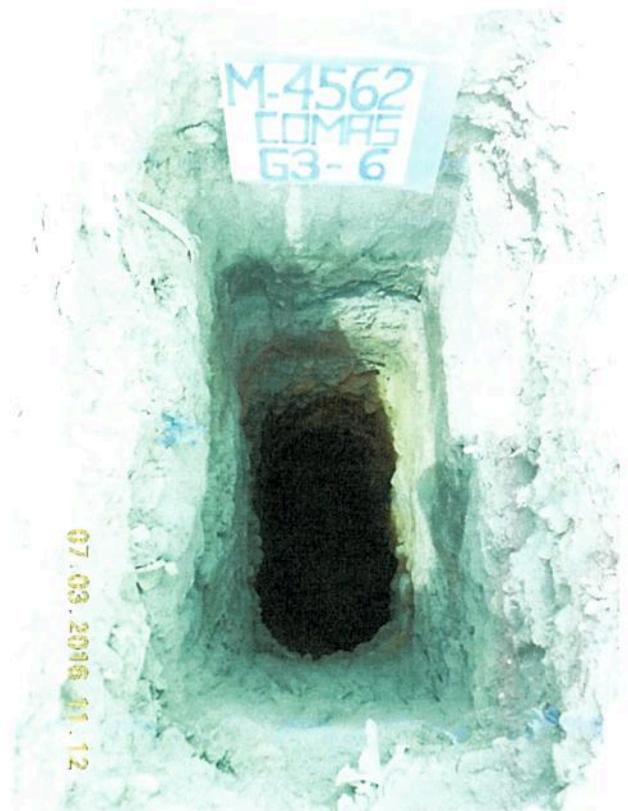
VISTA HACIA EL INTERIOR DE LA CALICATA G3-6. SE APRECIA LA CAPA SUPERIOR DE RELLENO ARCILLOSO, LIMOSO, CON RESTOS DE BASURA (PLÁSTICOS Y TRAPOS).
